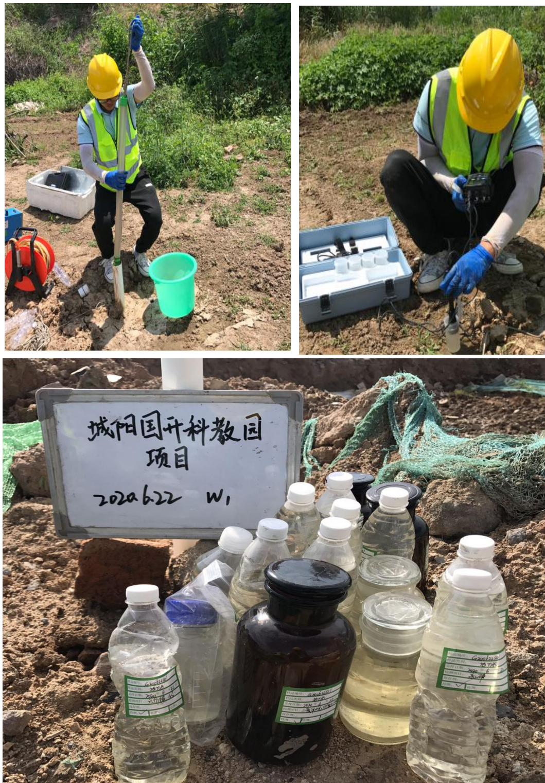
图 5.3-5 地下水洗井和采样照片
