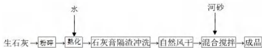
灰膏生产工艺流程图
